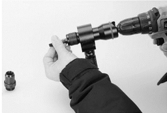
4. Nietmuttern-Zugdorn durch Drehen im Uhrzeigersinn fixieren
